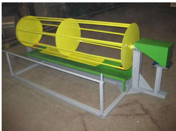
Скручивание поликарбоната в рулон – довольно трудоемкий процесс, в котором одновременно необходимо задействовать не менее трех человек. Специалисты завода «Металл-сервис» разработали инновационный способ механизации этой важной части работы с сотовым поликарбонатом.
